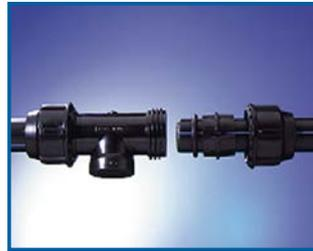
Fitting aufschrauben – Überwurfmutter, Klemmring und Dichtung auf das Rohrende schieben.
